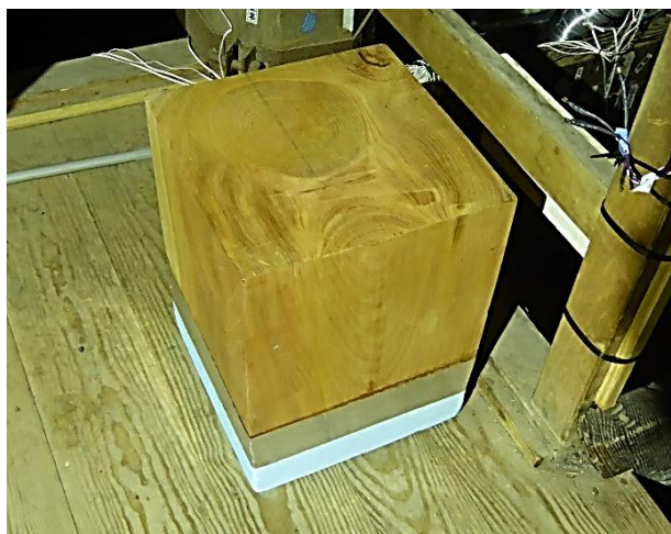
図 3-9 中禅寺鐘樓内部に設置した殺虫効果判定試験材
