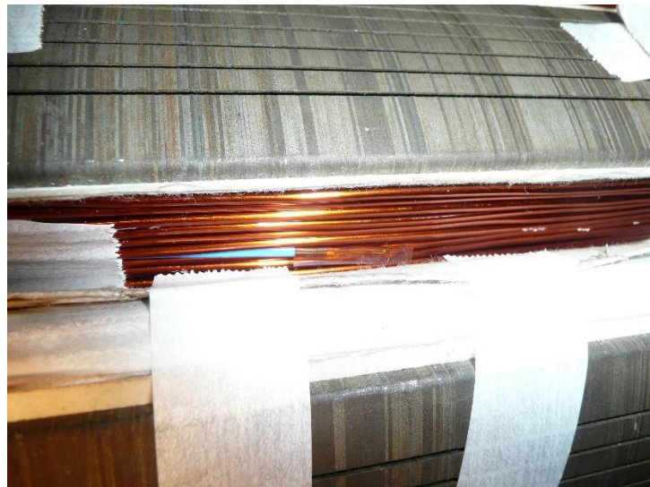
図 1.9 界磁巻線に埋め込んだ熱電対
