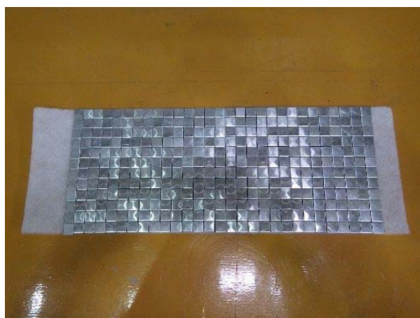
図-3.9 ブロックマット工模型写真（ケース2）
