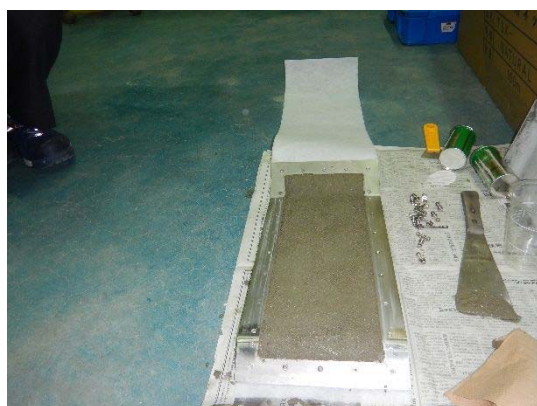
(手順3) モルタル設置完了.
