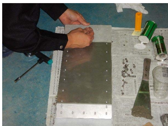
(手順5) 上面型枠固定→養生.
