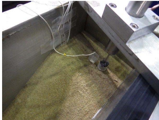
図-3.16 天端の変位計と加速度計
