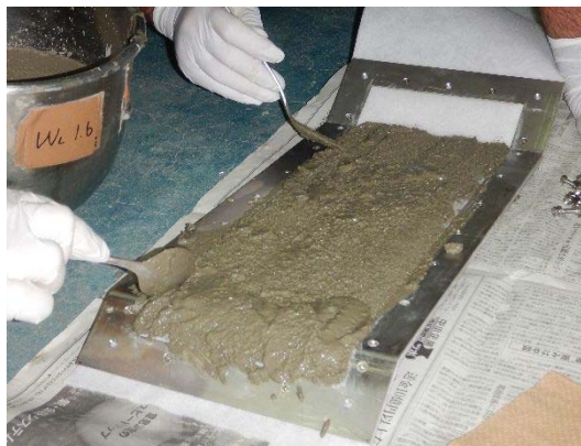
(手順2) 型枠内にモルタルを塗り込む.
