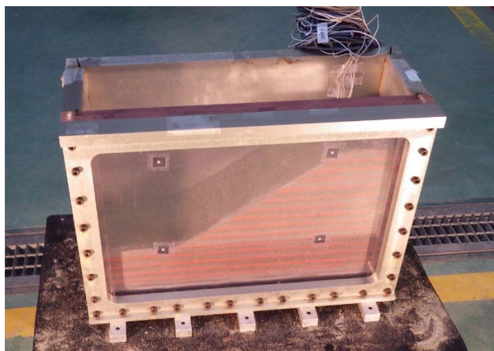
図-3.3 実験に用いた剛性土槽
