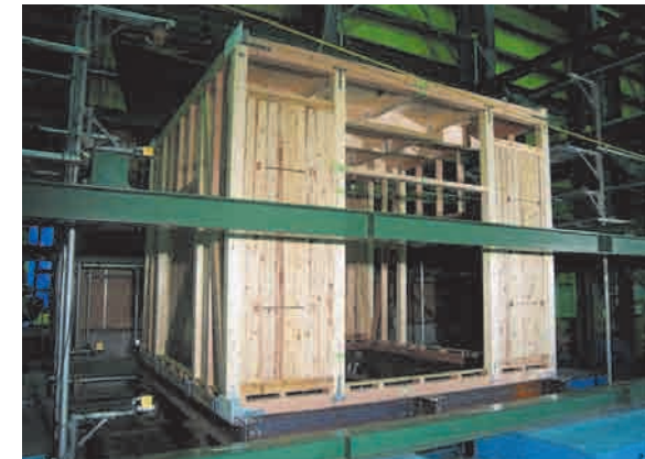
木造家屋試験体の設置状況
