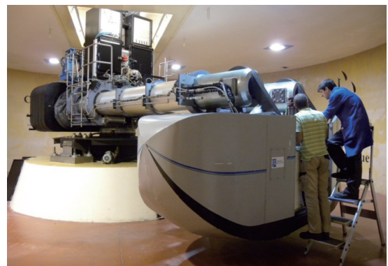
写真2 フランス中央土木研究所（IFSTTAR）の遠心力載荷装置
