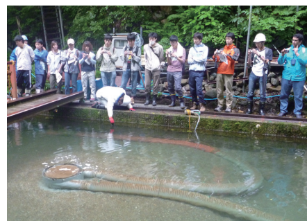
ヒル谷試験堰堤における土砂供給実験 (P10)
