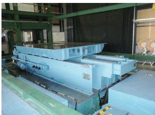
写真2 長周期振動実験システム
