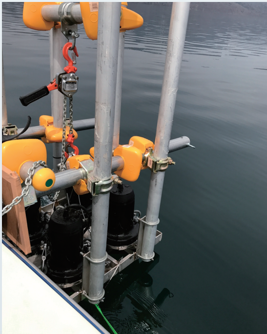
写真1 水上に引き上げられた状態の音波送受波器（黒色の部分）とアルミ管やステンレス枠で組まれた取り付け具。
