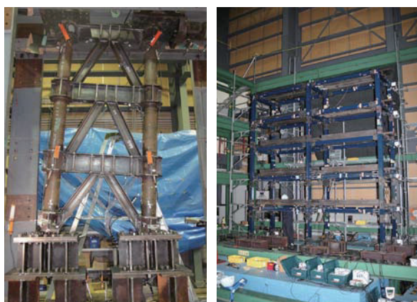
左：高強度CFT柱を用いたロッキングフレームの性能検証実験 Left: Testing of rocking frame with super high-strength CFT columns 右：被災建物の健全度判定システムの開発 Right: Development of structural safety assessment system for damaged structures
