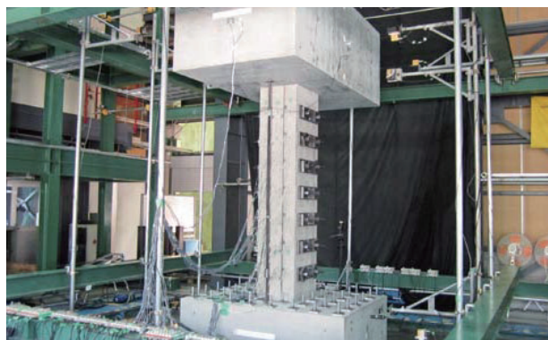
摩擦減衰機構を有する集合RC柱の振動台実験 Shaking table test for a RC column installing an advanced system
