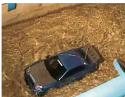
氾濫時の車の漂流に関する水理実験 Hydraulic experiment of a floating car in flooding
