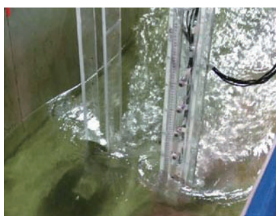
人体が受ける流体力に関する水理実験 Hydraulic experiment of fluid force acting on a human body
