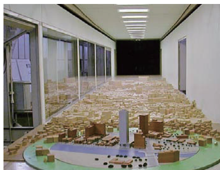
境界層風洞実験室 Boundary layer wind tunnel laboratory
