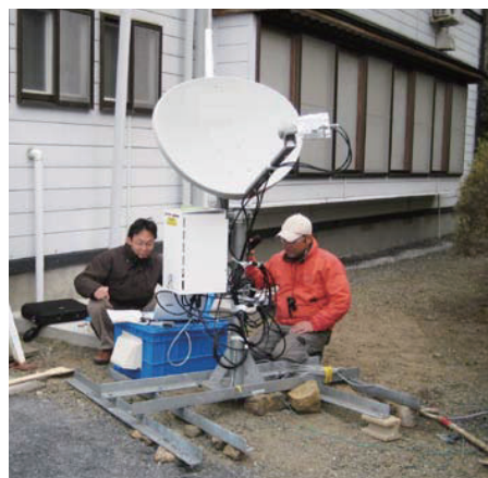
衛星通信を使ったリアルタイムデータ伝送 （東北地方太平洋沖地震緊急余震観測） Telemeter observation using a satellite data link
