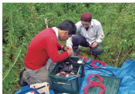
電磁気探査システムの設置 Setting up an electromagnetic survey system
