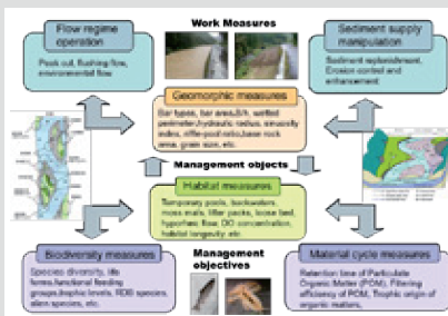
統合的流域管理のための河床地形管理手法の開発図式 Conceptual framework of the riverbed geomorphology management for integrated basin management
