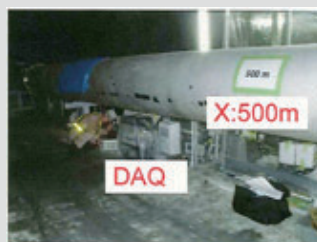
重力波望遠鏡KAGRAの安定動作のために併設された長基線レーザー歪計のデータ収録装置
