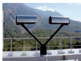
火山灰観測のためのディストロメータ Disdrometer for observation of volcanic ash
