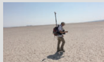
エチオピア・アファールのプレート拡大軸での磁気探査 Magnetic survey crossing the rift zone in Afar Depression, Ethiopia
