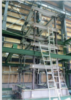
長周期構造物の振動実験における計測支援 Measurement support for the vibration test of a long period structure
