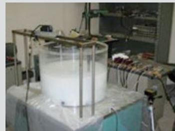
地震時に発生する液面揺動の制御デバイスの開発 New control device for liquid sloshing
