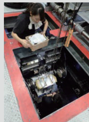
遠心模型実験に供する試験体の設置風景。 学生主体で進めるため安全指導が欠かせない。 Installing the specimen into the Centrifuge with students, trying to carry out the safety guidance
