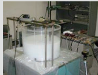
地震時に発生する液面揺動の制御デバイスの開発 New control device for liquid sloshing
