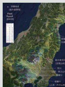
2019年台風19号を対象にした中小河川の洪水シミュレーション Flood simulation including small-to-medium sized rivers for the Typhoon Hagibis in 2019
