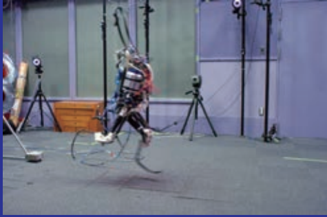
ヒトの筋骨格系が跳躍・走行といったダイナミック運動に果たす役割の解明と、その動作の工学的実現を目指して製作された脚ロボット。 (提供：新山龍馬・西川鋭・國吉康夫 [東京大学 知能システム情報学研究室])
