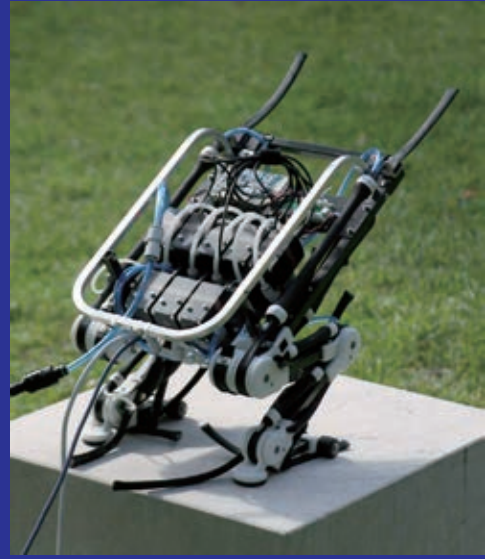
脊椎動物のダイナミックな跳躍・着地を実現する身体機能の解明を目指した2脚の跳躍ロボット。人工筋骨格系を組み込み垂直跳びや椅子への跳び乗りを実現した。(提供：新山龍馬・國吉康夫 [東京大学 知能システム情報学研究室]、長久保晶彦 [産業技術総合研究所])
