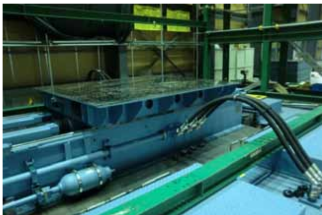
図6.8.1 長周期振動実験システム
