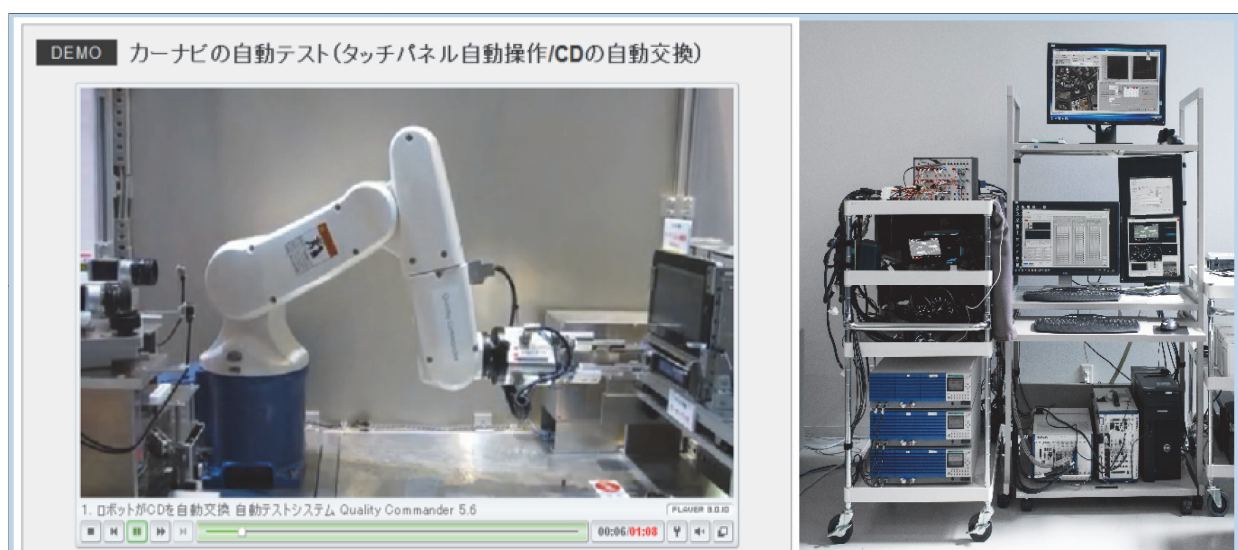
図6 高機能 HILS のロボットとコントローラ
