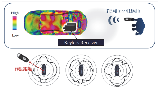
図8 キーレスエントリー性能CAE解析事例
