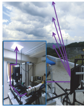
図4: (左) 走査型水蒸気ラマンライダーシステムの外観、(右) ライダーで取得された水蒸気混合比の鉛直断面図(信楽MU観測所 2012年8月28日22時17分)
