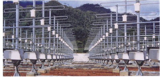
図3：赤道大気レーダーのアンテナ。
