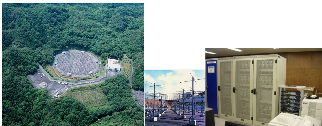
図 1: 信楽MU観測所全景（左）と MU レーダーアンテナアレイ(中央)、MU レーダー観測強化システムで導入された超多チャンネルデジタル受信機（右）。
