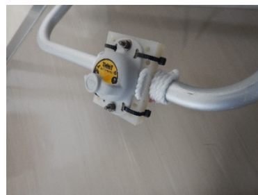
写真10：同径パイプへの仮設置
