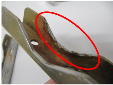
写真4：孔食が発生したSUS304製部材
