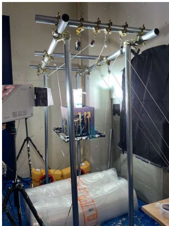
図7 自由落下装置全景
