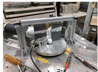
図4： \gamma - \gamma 摂動角相関法を用いたXeウルトラファインバブルの内圧測定の様子
