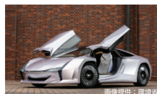
生存圏研究所で開発したCNF材料の応用例 (左：CNF材料を使用した自動車、Nanocellulose Vehicle: NCV (環境省提供)、右：CNF材料をクッション材に使用したランニングシューズ(株式会社アシックス提供))
