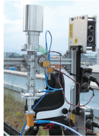
左：開発中の広帯域フィードアンテナ(16-64GHz) 右：これも搭載して大気中の水蒸気分布の高分解能観測を狙うNICT小金井2.4m広帯域アンテナ(現在はVLBI用3.2-16GHz)
