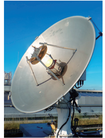
左：開発中の広帯域フィードアンテナ(16-64GHz) 右：これも搭載して大気中の水蒸気分布の高分解能観測を狙うNICT小金井2.4m広帯域アンテナ(現在はVLBI用3.2-16GHz)
