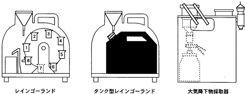
図-1 各種雨水採取器の構造
