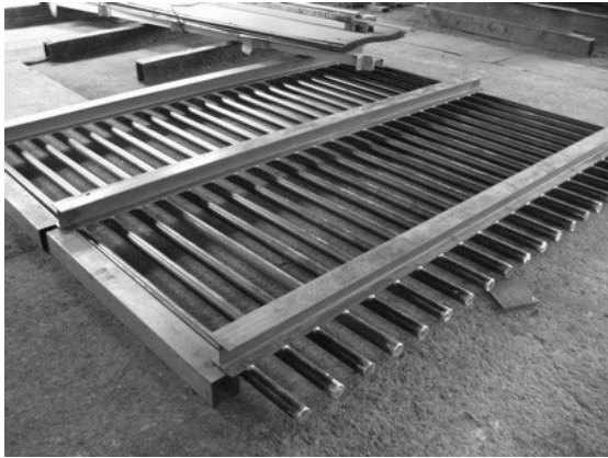
写真-15 鋼製床版パイプ (製作中)
