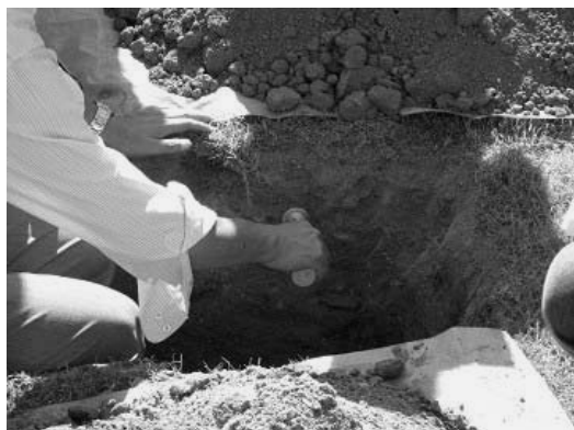
写真1 土壌硬度計による硬度の測定
