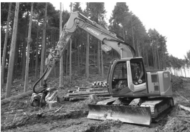
プロセッサ 総額約 2 千万円 玉切り作業 集材はタワーヤーダー 運材はフォワーダー
