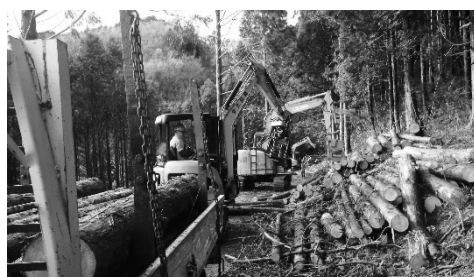
グラップルによる出荷トラックへの積込
