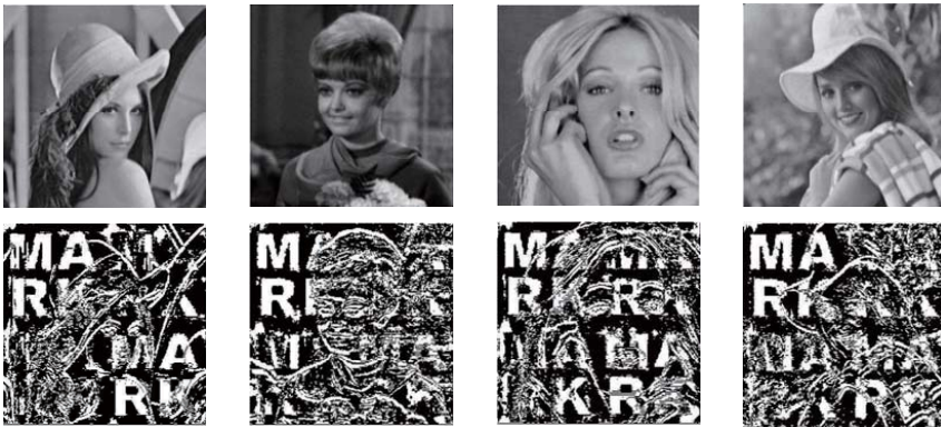
図 16: メディアンフィルタリング (マスク長が 3 \times 3 ) を適用した透かし入り画像とそれから抽出した透かし画像
