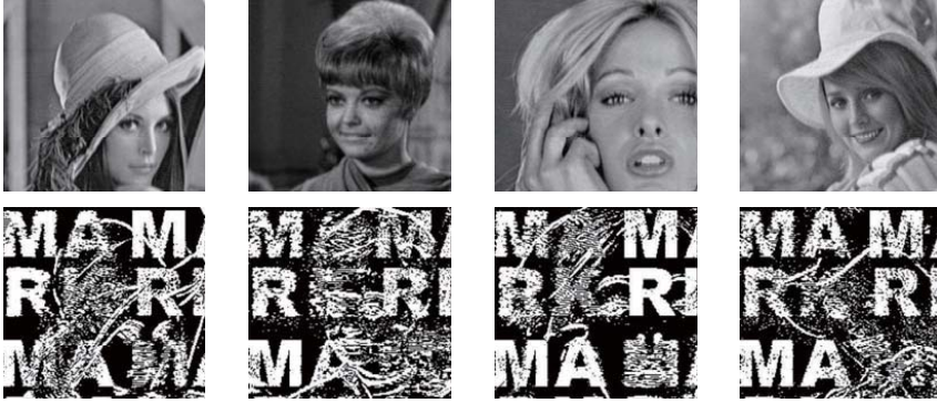
図 18: 190 × 190 ピクセルに切り取った透かし入り画像とそれから抽出した透かし画像
