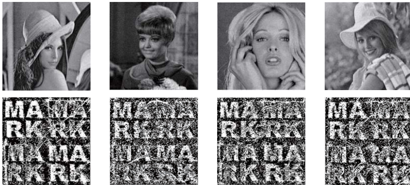
図 17: 白色ガウシアンノイズ（平均：0，分散：0.001）を付加した透かし入り画像とそれから抽出した透かし画像
