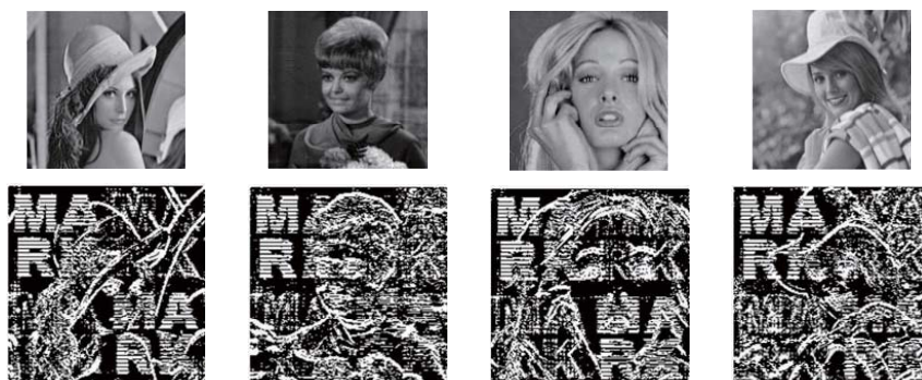
図 21: 縮小 (0.8 倍) した透かし入り画像とそれから抽出した透かし画像
