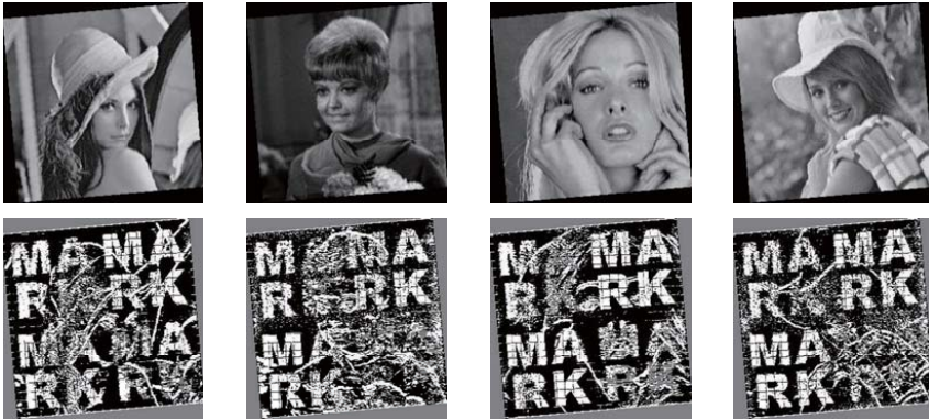
図 19: 回転操作 (回転角:5°) した透かし入り画像とそれから抽出した透かし画像
