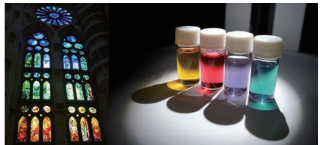
ステンドグラスと各種金属ナノ粒子のコロイド溶液 (左から Ag, Au, PtIn 2 , PdIn)
