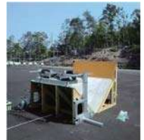
反射板素材 コンパネ + コンクリート平板
