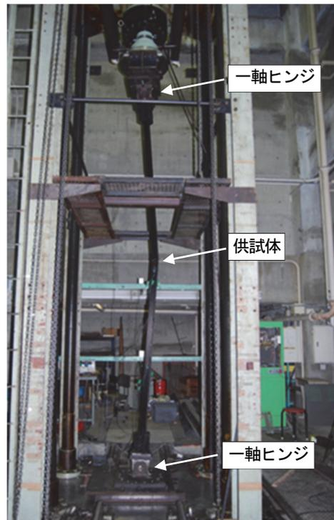
図-2 圧縮耐荷力実験の様子
