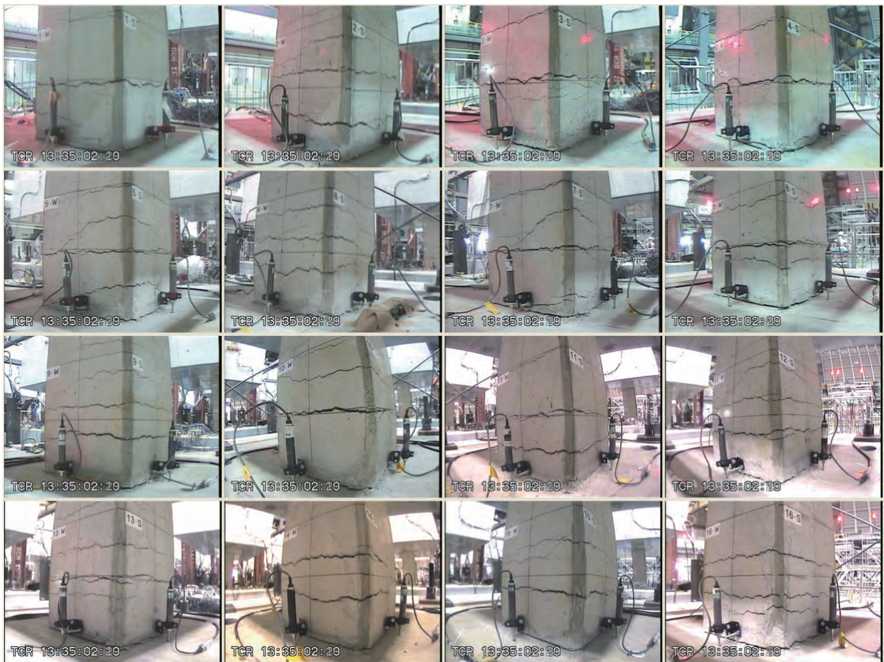
図-13 16体の100%加振における最大応答変位時の損傷状況
