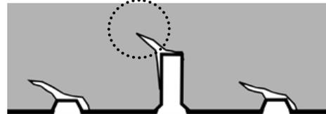
図-2 節加工によるかぶりコンクリートの減少
