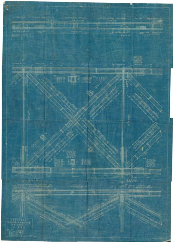
図-9 複斜材型トラス桁のパネル部図面 (所蔵：安藤ハザマ)
