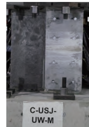
図5 補強を施した RC 柱の 実験試験体
