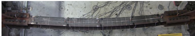
図6 ブレース実験試験体
