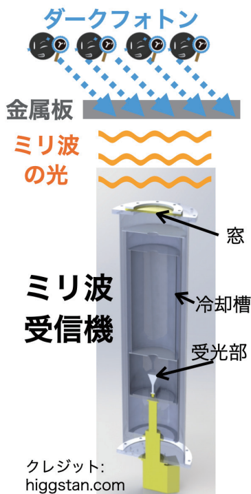
図1 ダークフォトンの検出方法。金属板でダークフォトンが微弱なミリ波の光に転換される。開発する高感度ミリ波受信機で、この光を捉える。
