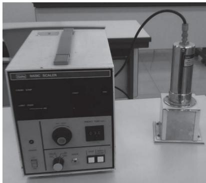
図 3-4 使用する GM 計数管とスケアラ
