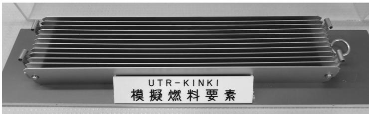
図 1-7 原子炉燃料体の写真 (模型)
