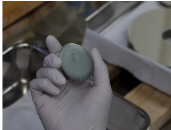
京女望遠鏡の主鏡および斜鏡（飛騨天文台にて分解調査、参考文献の図5）
