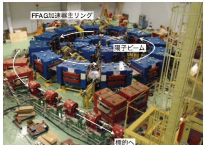
図. FFAG加速器全景。直径約10メートルの主リング中を陽子ビームが周回しながら加速される。
