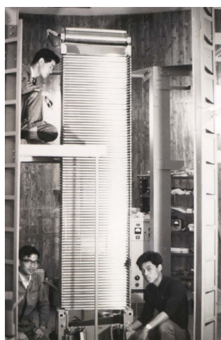
Fig.3. 5MV Van de Graaff accelerator.
