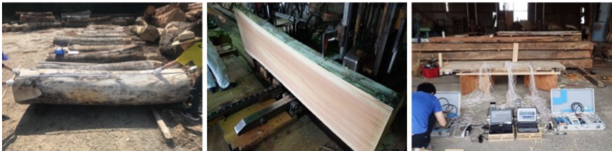
図 1. 丸太の準備から残留応力の測定まで
