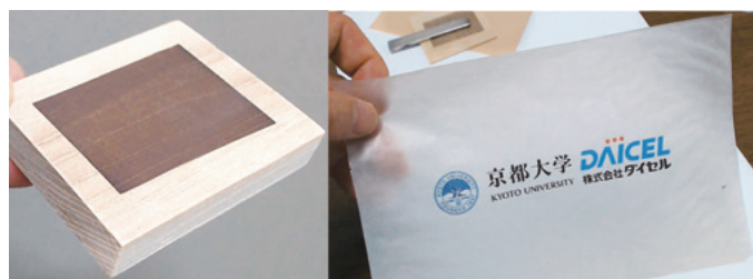
【写真3】おが屑をギ酸に溶かして作ったバイオマスフィルムを熱圧した表面加工木材(左)とバイオマスフィルムの漂白シート(右)
