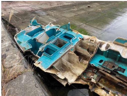
写真-1 穴喰漁港で漂流した漁船の損傷状況
