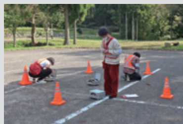
アレイ微動観測による地下構造調査
