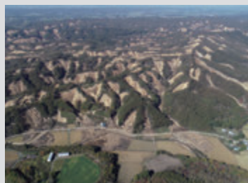
2018年北海道胆振東部地震時に群発した斜面崩壊(厚真町・高丘地区)
