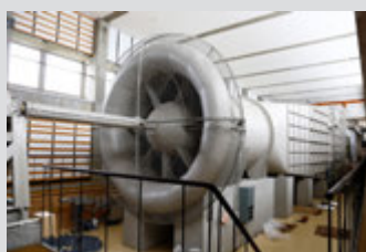
境界層風洞実験装置。建物に加わる風圧力や風環境に関する実験を行います
