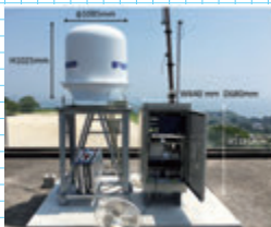
火山噴煙検知のためのXバンドMPRレーダー
