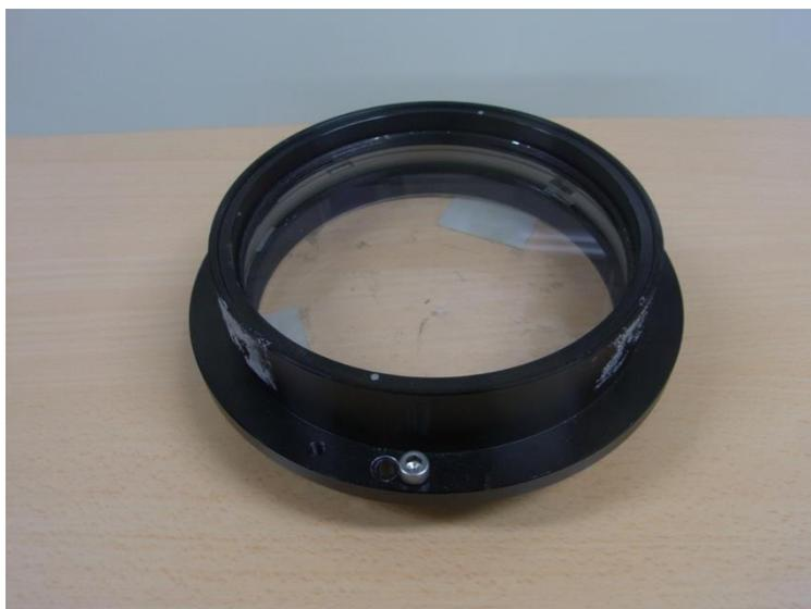
図 19. センサー光学系用に用いた再結像レンズ。口径 15cm、焦点距離 2200mm。メキシコ日食 (1991 年) に使用したものを流用。
