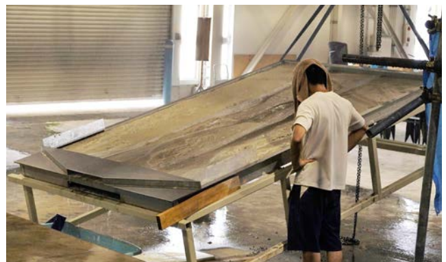
写真5 裸地斜面の侵食実験
