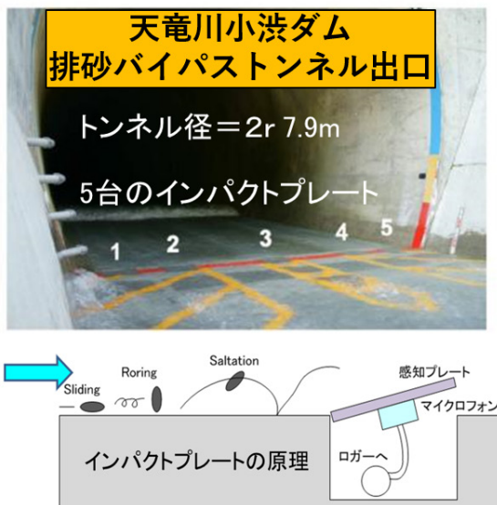
図2 排砂バイパストンネルの摩耗損傷事例と流砂量観測(小渋ダム)
