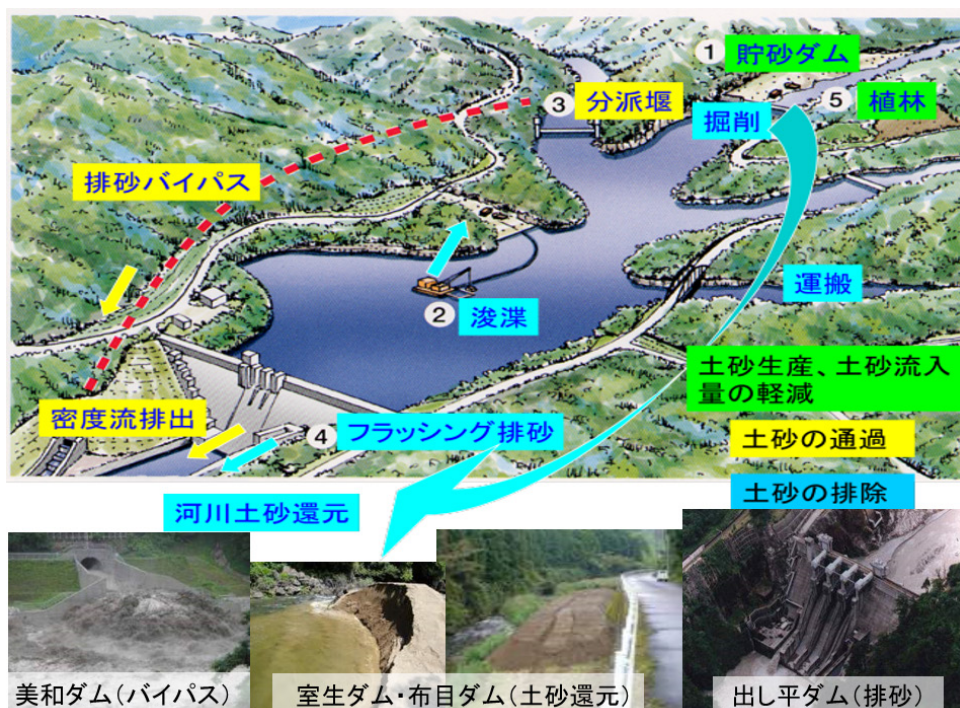
図1 ダムの堆砂対策の類型
