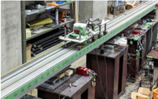
図4 室内実験の模型車両と橋梁
