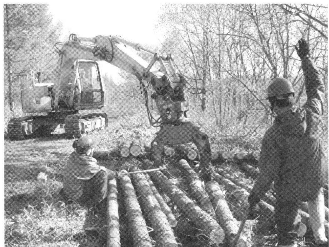
グラップルによるはい積み作業
