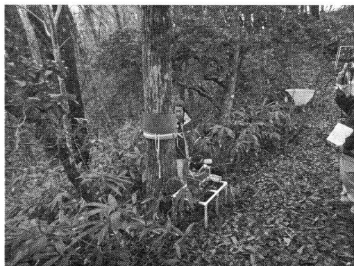
写真 1 樹幹流を採取する装置の説明
