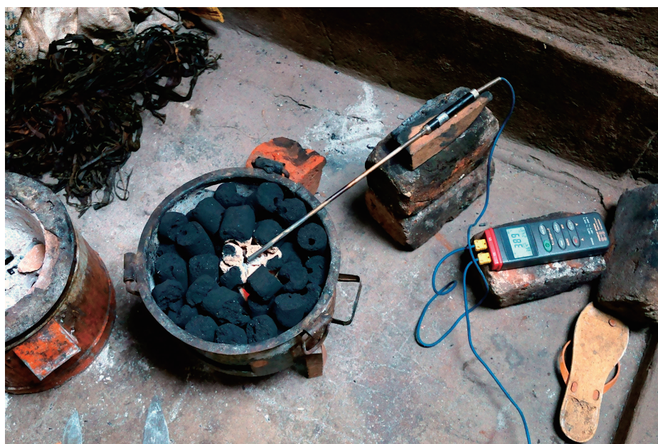
写真4 燃料の着火直後に設置したセンサーとデータロガー
