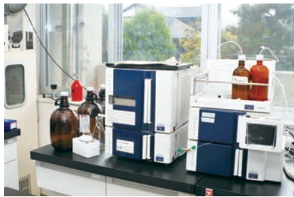
COVER 研究ハイライト「分子レベルのモノづくり」より 高速液体クロマトグラフ
