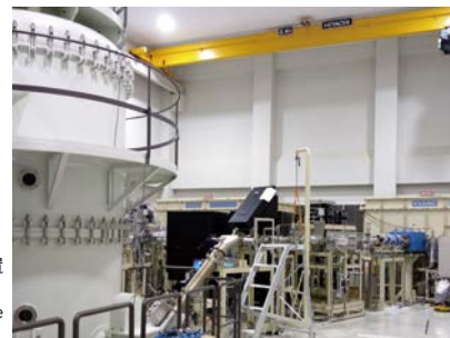
▶ 北海道大学に設置されている超高圧電子顕微鏡に設置されたレーザー照射装置 Laser irradiation equipment appended on high-voltage electron microscope at Hokkaido University
