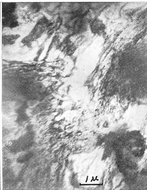
Photo. 22. Mg-11.6%Al alloy, W.Q., 60% roll ed. ( \times 10,000 )
