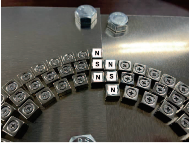
図5 磁力によってパーツがずれる様子。
