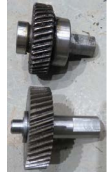
写真5 アーマチュア 写真6 メインシャフト (それぞれ、上が交換前、下が新品)
