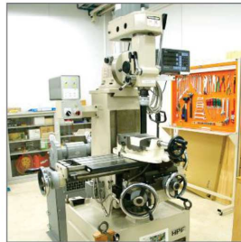
フライス盤 平面・溝の加工
