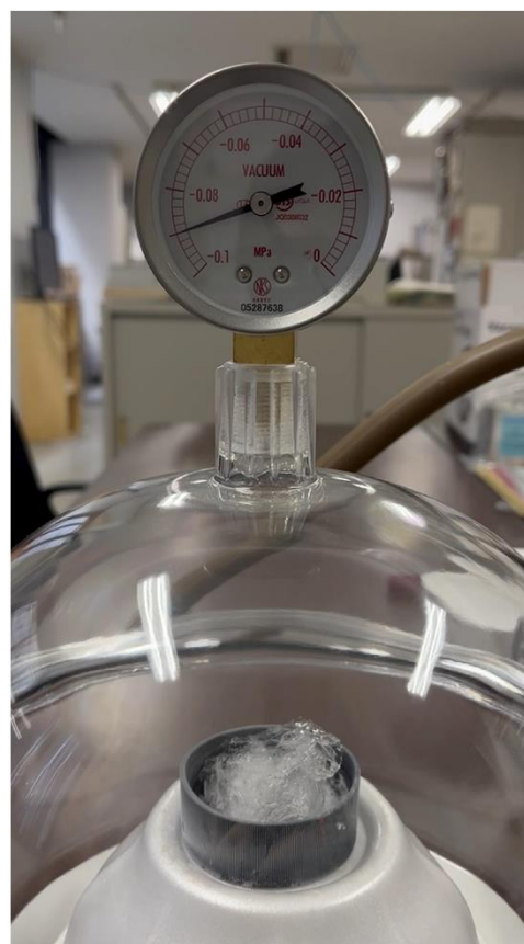
図 2. 固体窒素生成の様子。
