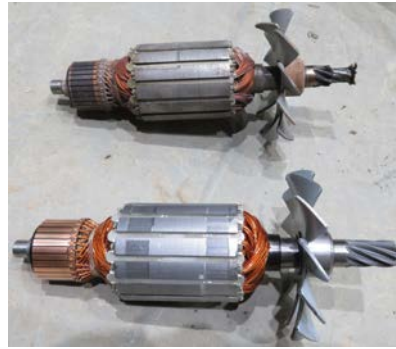
写真5 アーマチュア 写真6 メインシャフト (それぞれ、上が交換前、下が新品)
